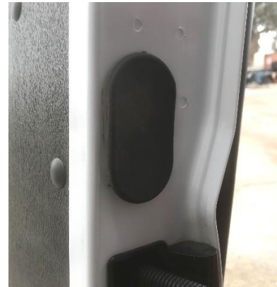
Figure 19: Remove Rubber Door Grommet
