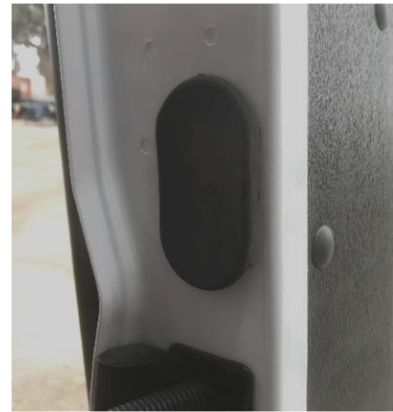
Figure 10: Remove Rubber Door Grommet
