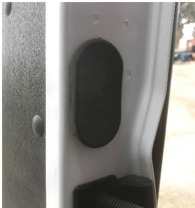
Figure 18: Remove Rubber Door Grommet
