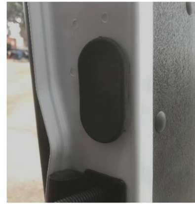
Figure 10: Remove Rubber Door Grommet
