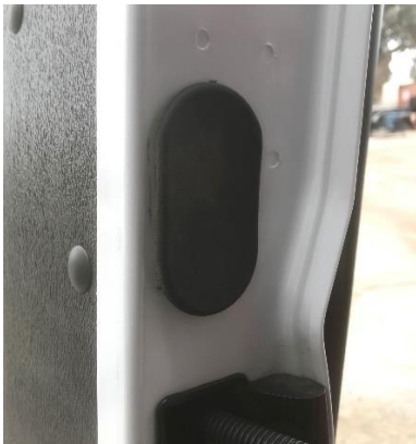
Figure 18: Remove Rubber Door Grommet
